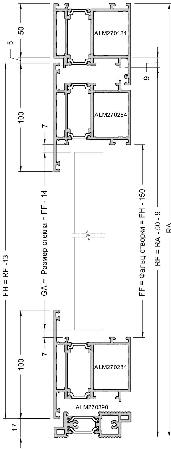
7.6. Определение вертикальных размеров двери с цоколем без притвора
