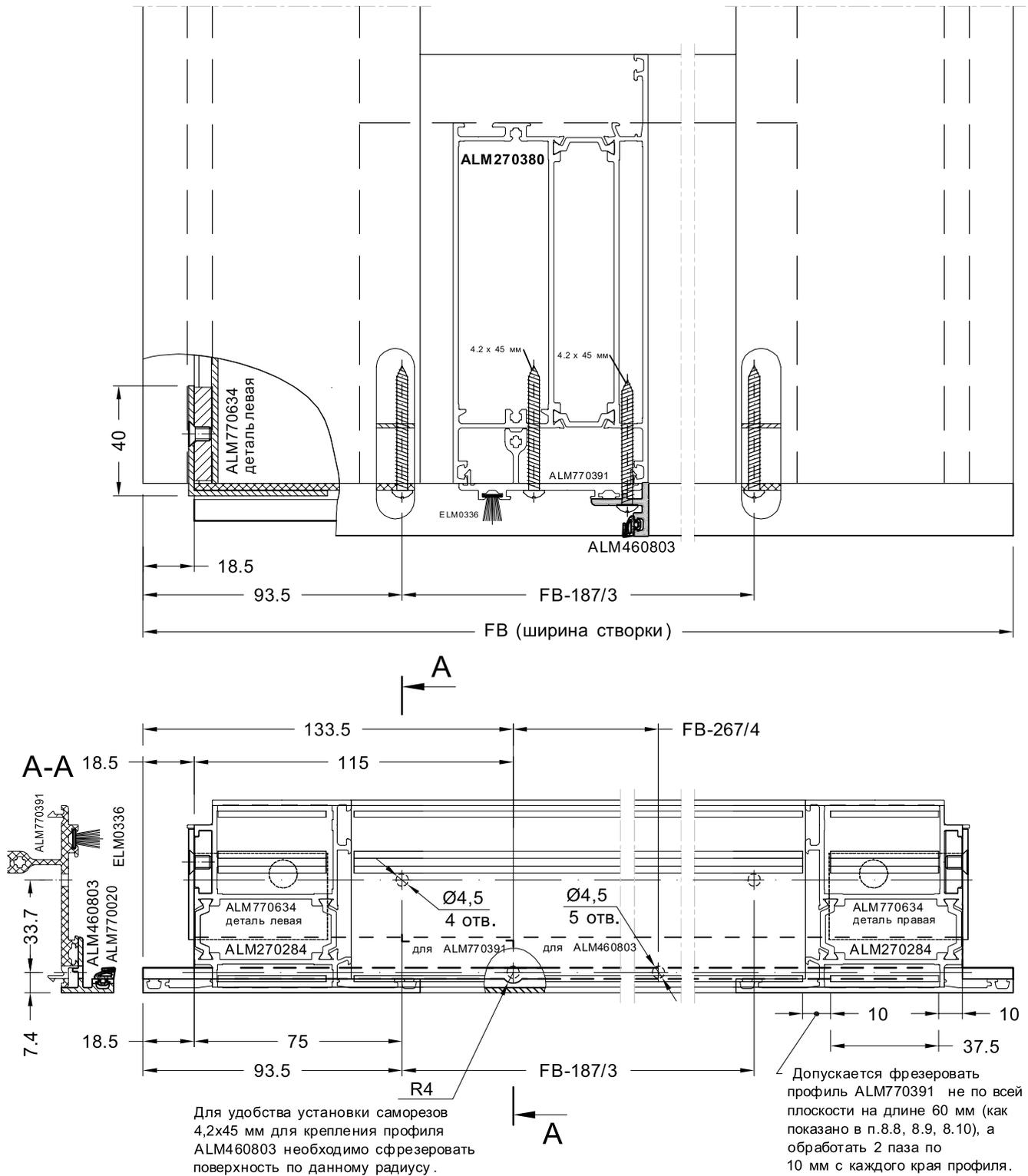
Для удобства установки саморезов 4,2x45 мм для крепления профиля ALM460803 необходимо сфрезеровать поверхность по данному радиусу.
