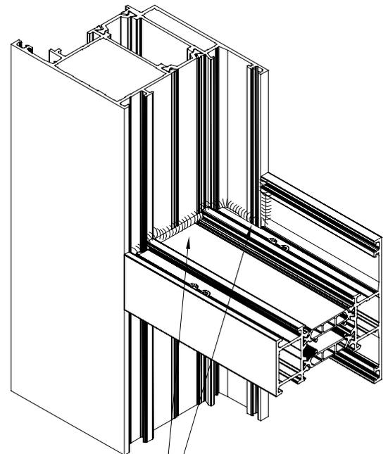
Герметизировать стык створки и импоста в верхней камере фальца уплотнительной массой на основе этиленпропиленового каучука (EPDM)
