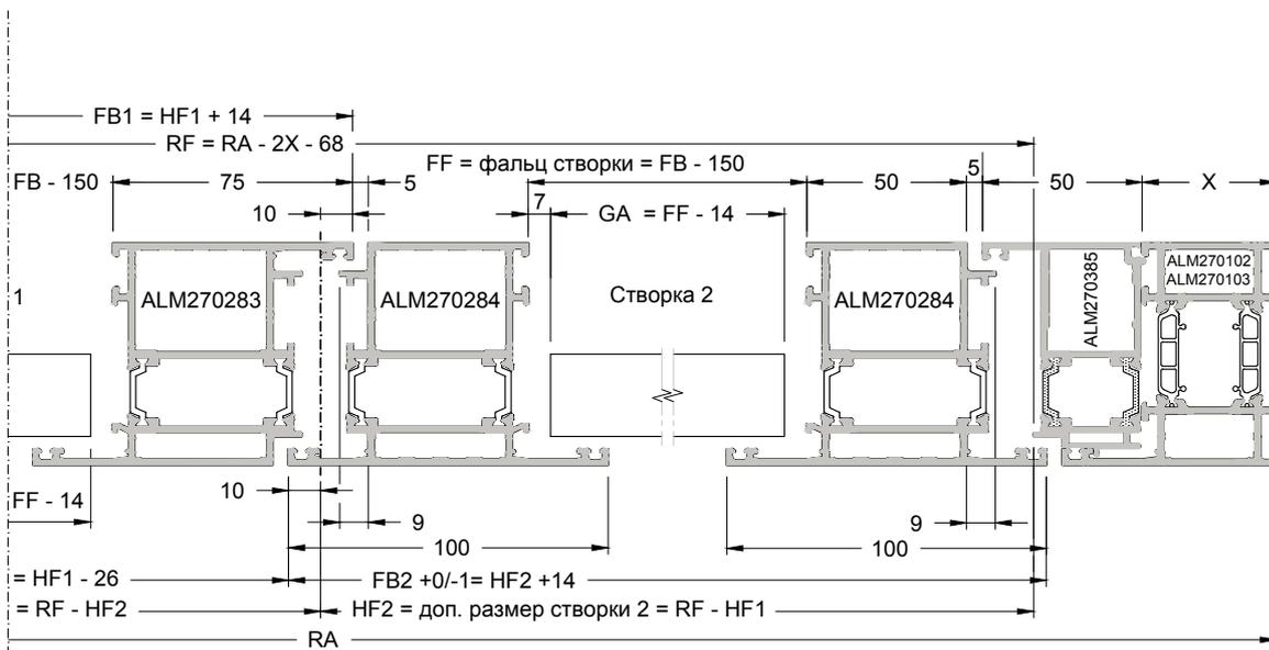
7.4. Определение вертикальных размеров двери без порогового притвора
